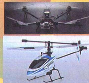
Drones con Rotores: son los Helicópteros y los Multirrotores.
